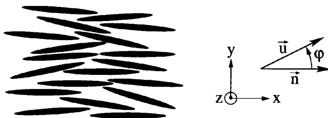
Figure 1 – Cristal liquide en phase nématique. Le directeur \vec{n} est selon l'axe du bâtonnet. Le vecteur unitaire \vec{u} définit la direction du vecteur d'onde de l'onde électromagnétique traversant ce milieu.
