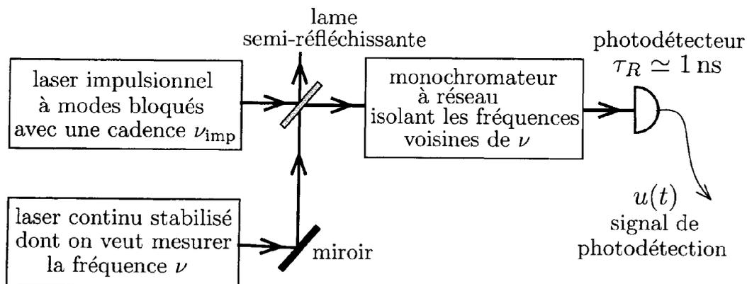
Figure 7: Comparaison de fréquences entre un laser stabilisé et un laser impulsionnel à modes bloqués. On rappelle que le photodétecteur délivre un signal électrique  $u(t)$  proportionnel à l'intensité  $I(t)$  qu'il mesure sur le faisceau lumineux détecté.
