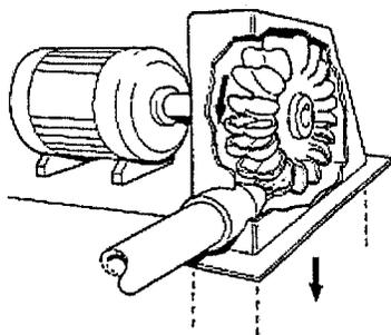
( $f = 12,5 \text{ Hz}$ ). Ce rotor est assimilé à une bobine alimentée par un courant continu  $I$  créant un champ magnétique tournant bipolaire (deux pôles magnétiques). Le stator est constitué de trois enroulements identiques  $E_1, E_2$  et  $E_3$  décalés l'un par rapport à l'autre de  $\frac{2\pi}{3}$ . On note  $\hat{u}_i$  ( $i=1,2,3$ ) le vecteur unitaire de l'axe porté par la bobine n°  $i$ . On admet que le flux de  $\mathbf{B}$  à travers chacune des trois
