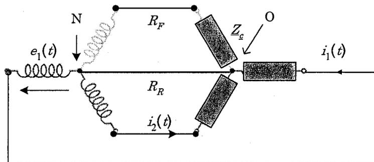
Fig. 5 - Symboles et conventions pour enroulement et charge triphasés.
