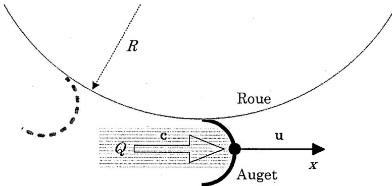
Fig. 3 - Portion de roue et un auget ; les vitesses sont représentées dans  $\{L\}$  ; dans le référentiel lié à l'auget, la vitesse du jet incident serait  $c - u$ .
