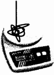
La table est ici le plateau d'une balance électronique. On duplique la seconde expérience de la partie A : corde verticale, vitesse initiale nulle et mouvement de B uniformément accéléré.
