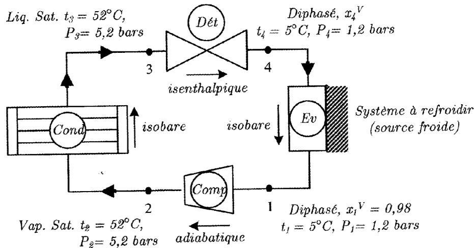
Fig. 3 – Schéma, notations et valeurs pour le système primaire de climatisation ;
