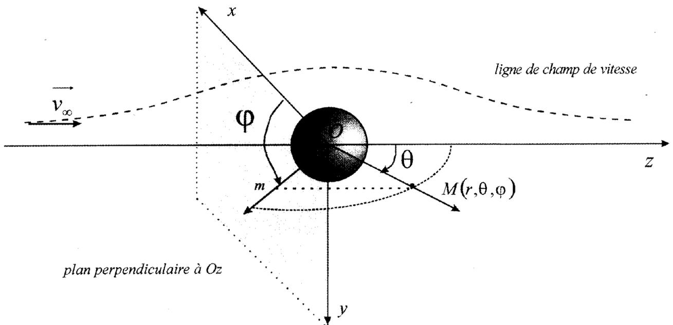
L'angle  $\theta$  est l'angle entre  $\vec{OM}$  et  $\vec{e}_z$  et l'angle  $\varphi$  est l'angle entre  $\vec{Om}$  et  $\vec{e}_x$ , vecteur unitaire de l'axe Ox,  $m$  étant le projeté orthogonal de  $M$  dans le plan  $(O, x, y)$ .
