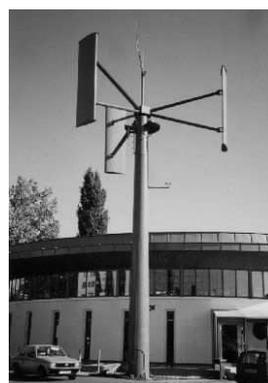
FIGURE 1 – Éolienne de type Darrieus.
